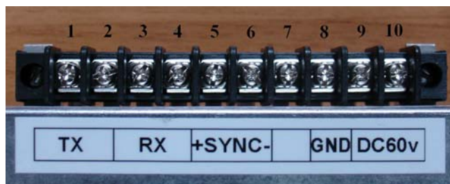
Рис. 2 Внешний вид клемм БС6-Е1
